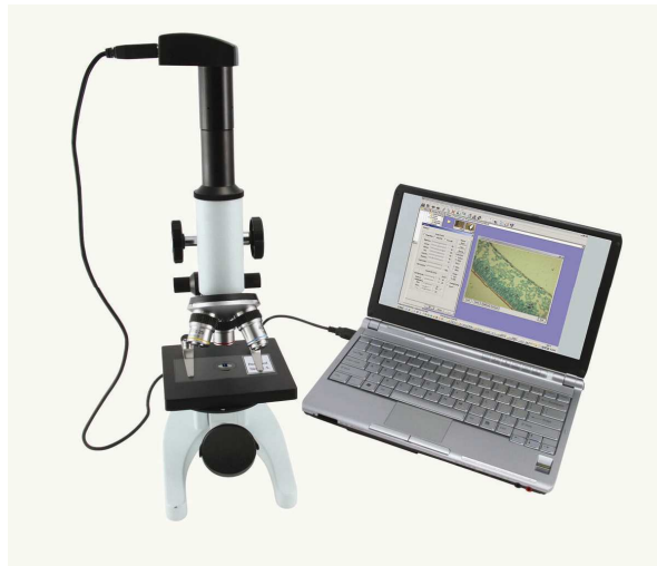
Reproductor de imágenes conectado a su ordenador y su microscopio
